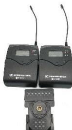
Přenosný bezdrátový přijímač pracuje v rozsahu 740-776 MHz. Napájení zajišťuje dvojice AA článků. Symetrický audio výstup je přes TRS Jack 1/8". Vhodné pro montáž na kameru nebo jako "bodypack".
