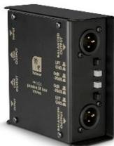
Adaptuje zdroje signálu s velkou výstupní impedancí (v řádu desítek kilo Ohm) na potřeby nízk impedančního vstupu předzesilovače (v řádu stovek Ohm) pomocí transformátoru. Vstupní impedance DI boxu je 60k Ohm a výstupní je 600 Ohm. Převádí nesymetrické signály na symetrické. Umožňuje také zařadit útlum o -30dB a případně odpojit zemní vodič na výstupu symetrického vedení. Box je dvoukanalový. Využívá se při záznamu elektroakustických a elektronických hudebních nástrojů, eliminuje
