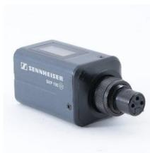
Násuvný vysílač, který je možné připojit do dynamického mikrofonu (například SM58) přes konektor XLR-3F (nesymetricky). Napájení zajišťuje dvojice AA článků. Pracuje v rozsahu 740-776 MHz. Vysílač je vhodný pro reportáže, konference, veřejné ozvučení.
